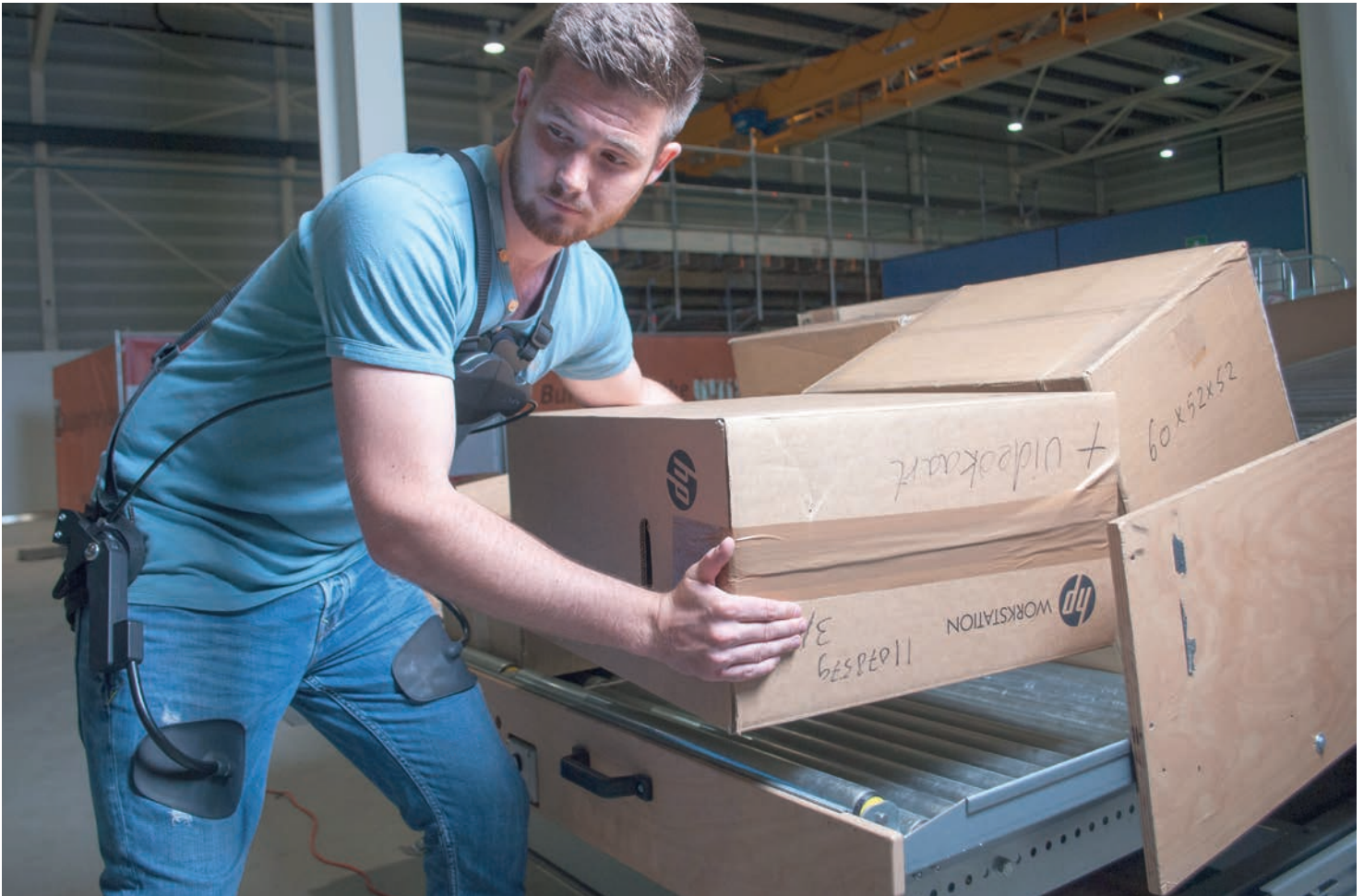
Bij het order picken wordt de picker ondersteund via het skelet]
